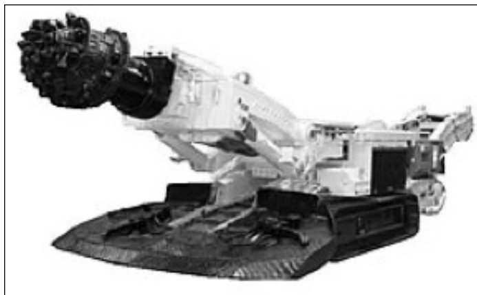
Слика 1 – Ротационо-лачна машина опремена со пикови
