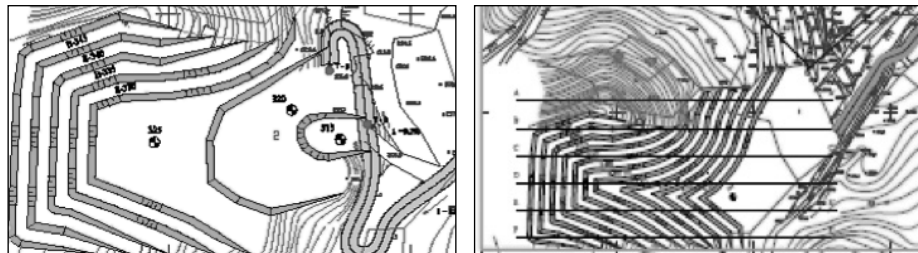
Слика 2 - Развој на површински коп за 5 год. и за 10 год.
