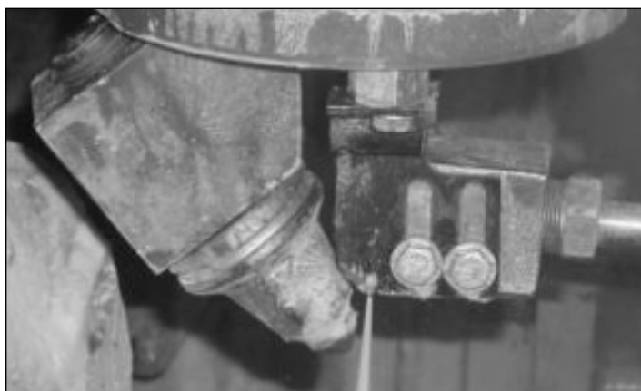
Слика 2 – Конфигурација на заемно дејство на алат-пик и воден млаз
